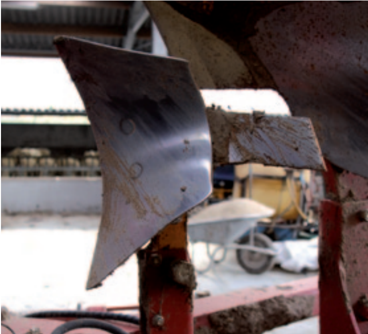
▲ Ook de brede voorscharen zijn omkeerbaar en beveiligd met een breekbout. Belangrijk als je over de vorst ploegt.
