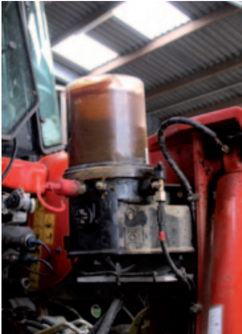
▲ Een smeersysteem is een prijzige optie. Maar met vijftig smeernippels wel handig.
